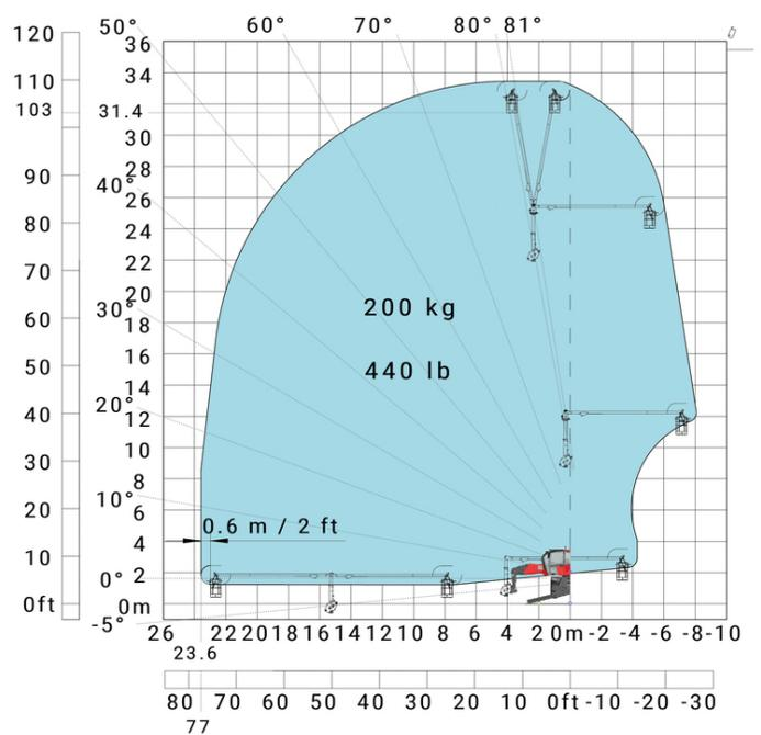
Drehung mit abgesenkten Stützen mit 3D negativ
