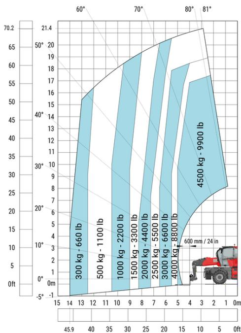
Drehung mit abgesenkten Stützen mit Gabeln
