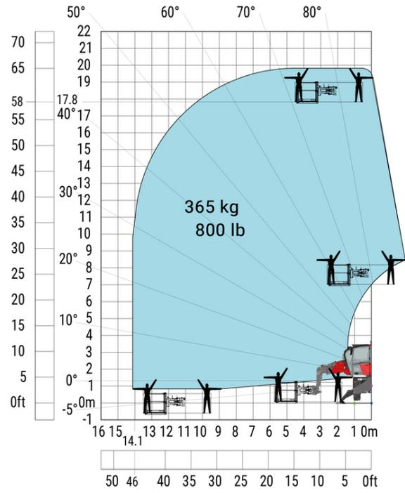
Drehung an abgesenkten Stützen mit 1000 kg Arbeitskorb
