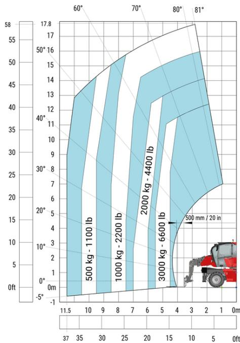
Drehung mit abgesenkten Stützen mit Gabeln
