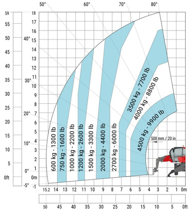
Drehung mit abgesenkten Stützen mit Seilwinde 5000 kg
