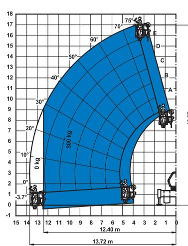
Mit drehbarer Arbeitsplattform mit Abstützungen
